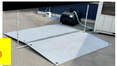
【セット内容】・スロープ敷鉄板・ステンレス配管・ノズル・タンク・ドサトロン・噴霧ポンプ・制御盤・押しボタンスイッチ2段・自動排水弁等
